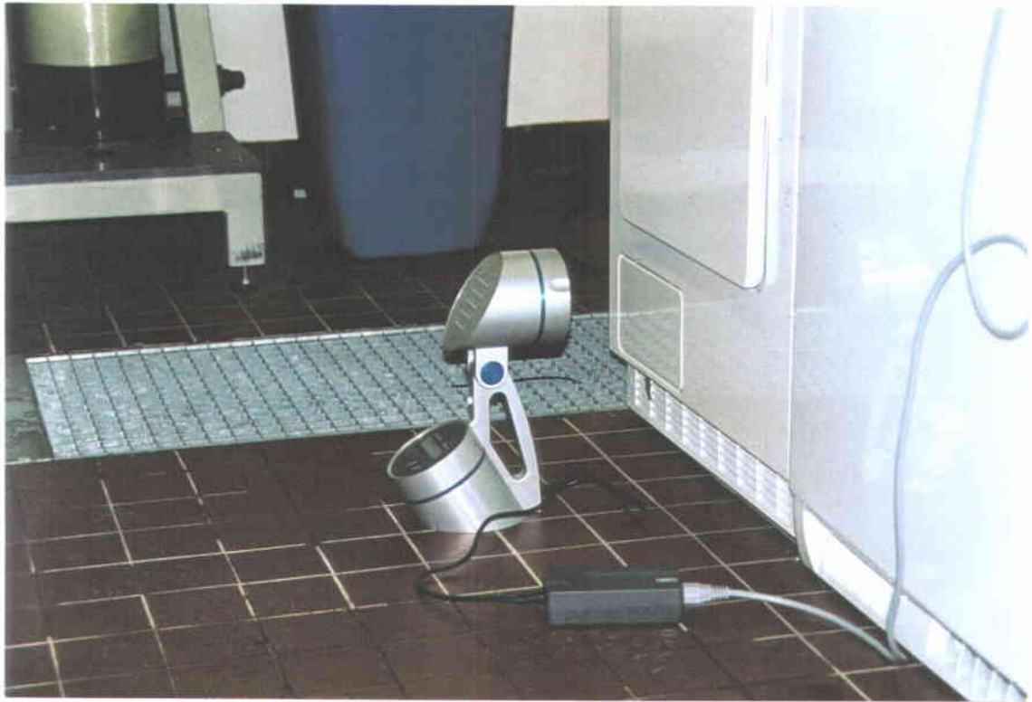
Afbeelding 4. Aërosolsampler bij de condensopvangbak en deur van een condensdroger.
