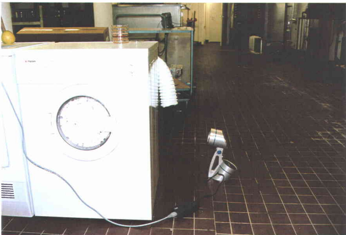
Afbeelding 3. Aërosolsampler bij de luchtuitlaat van een luchtdroger.
